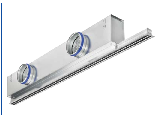
Cutie plenum mai scurtă decât masca anemostatului, poziție stânga, cu două ștuțuri de racord laterale
