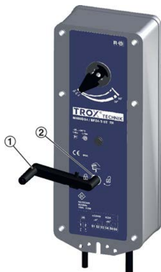
Fig. 125: Test funcțional (fără tensiune)
