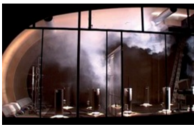
Teste de flux de aer: Simulări pe machete în laboratorul de cercetare și dezvoltare TROX
